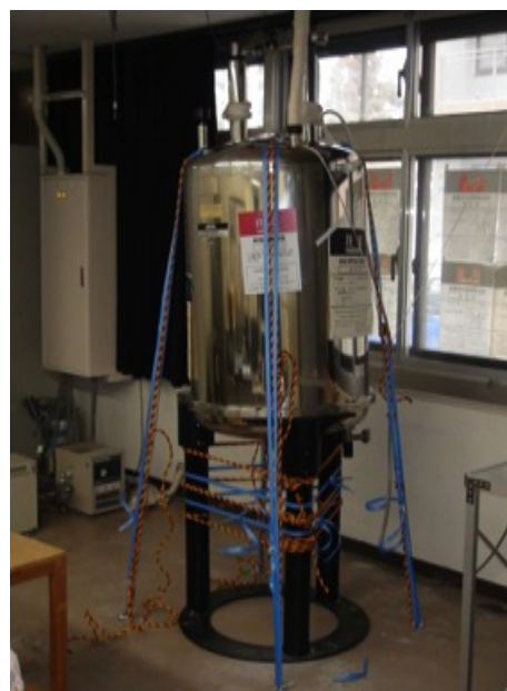
倒壊防止対策を行い、液体窒素と液体ヘリウムが抜き取られた後の超伝導マグネット。
