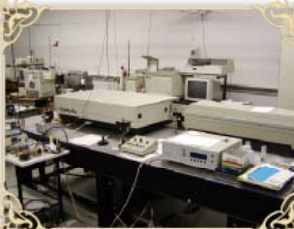
ワークステーション（左：CHARMM/QUANTAなど分子設計や分子動力学計算に利用）と、レーザー分光システム（右：研究室では過渡吸収スペクトルや時間分解IRが測定できます）
