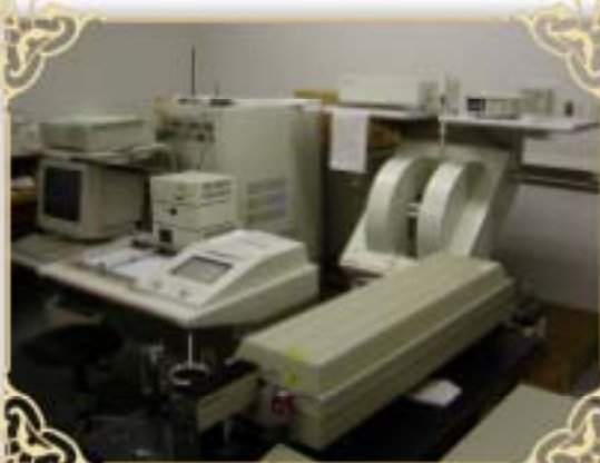
NMR（左）とESR（右） 主に使用するNMRにはBrukerの300 MHzと、JEOLの400 MHzがあります
