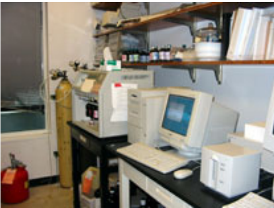
核酸合成機。非天然塩基を含むDNAの合成は当然自前です。
