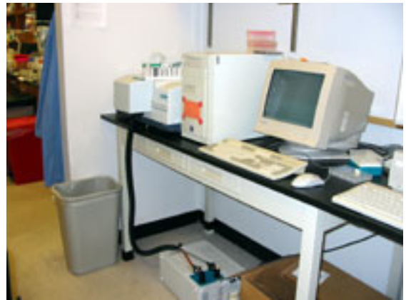
合成したDNAの T_m 測定はUV-VIS分光計で。
