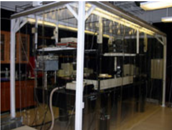
フェムト秒単位での分子の振動をレーザーで測定する装置です。
