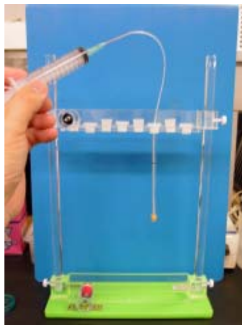
図5 アガロース溶液の注入 (ミニゲルの場合)
