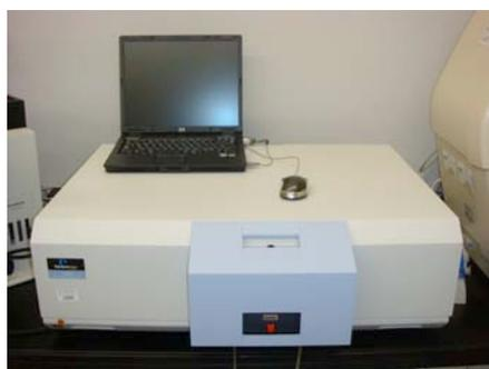
図4. Perkin 社製 LS55 蛍光測定装置
