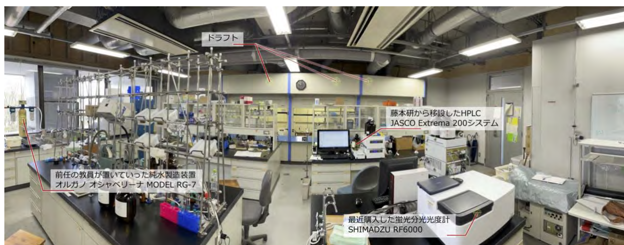
図2. 現在の研究室の様子。狭いながらもドラフトが3台あり、一般的な有機合成なら十分行えます。また、吸収・蛍光スペクトル解析や T_m 測定、ゲル電気泳動、PCR など、核酸研究を行える最低限の環境を整えることができました。写真には写っていませんが、オートクレーブ、ディープフリーザー、冷却遠心機、凍結乾燥機なども揃っています。
