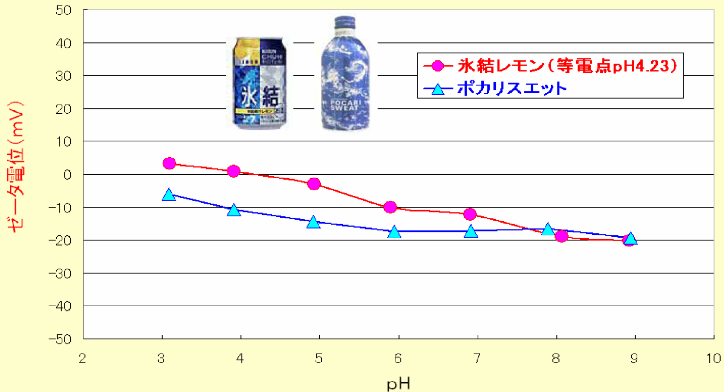
氷結レモンとポカリスエットのゼータ電位のpH依存性
