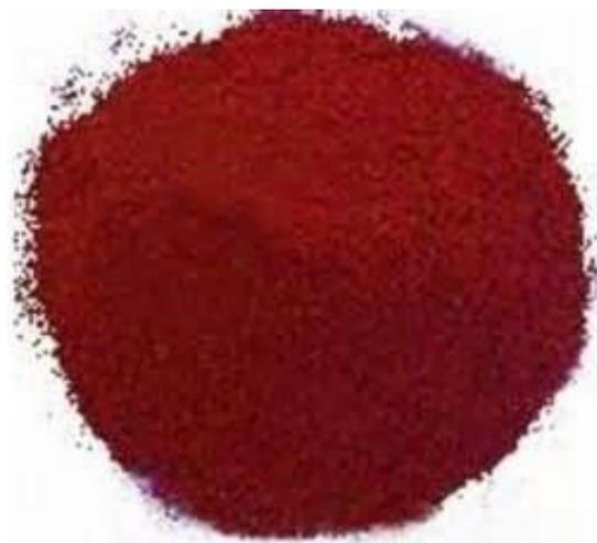
赤い色の原因は，第一鉄イオン(Fe(II))が酸化され，加水分解を起こして，固相析出した，水酸化鉄  $\text{Fe}(\text{OH})_3$ あるいは，含水酸化鉄  $\text{FeOOH}$ である．一部は，ヘマタイト  $\text{Fe}_2\text{O}_3$ になっている．数ミクロン～数ミリの粒子であり、分散している．
